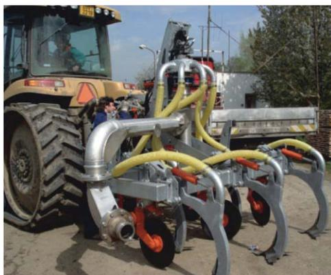
Aplikátor s 5 radlicami a pracovnou šírkou 2,5 m. Napájanie aplikátora je riadené hydraulickým rozdeľovačom. Radlice aj rezacie disky sú nastaviteľné hydraulickým systémom. Na použitie je potrebný traktor s výkonom 140 koní. Zariadenie je vybavené otočnou-napájacou trubicou s rýchlospojku, ktorou sa zabezpečuje spoľahlivé
