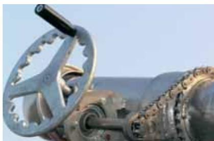
**IT** Dispositivo rotazione dell'ugello di miscelazione.
