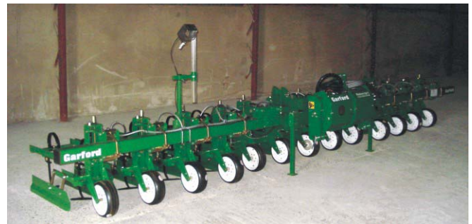
Kombinácia pre 12 riadkov cukrovej repy s konverziou na 8 riadkov kukurice. Multiplikačný efekt prináša aplikátor postrekov do riadkov plečkových plodín.
