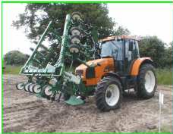
6 metrový hydraulický skladateľný rám
